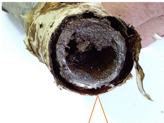
給湯器と配管の継手の断面図
